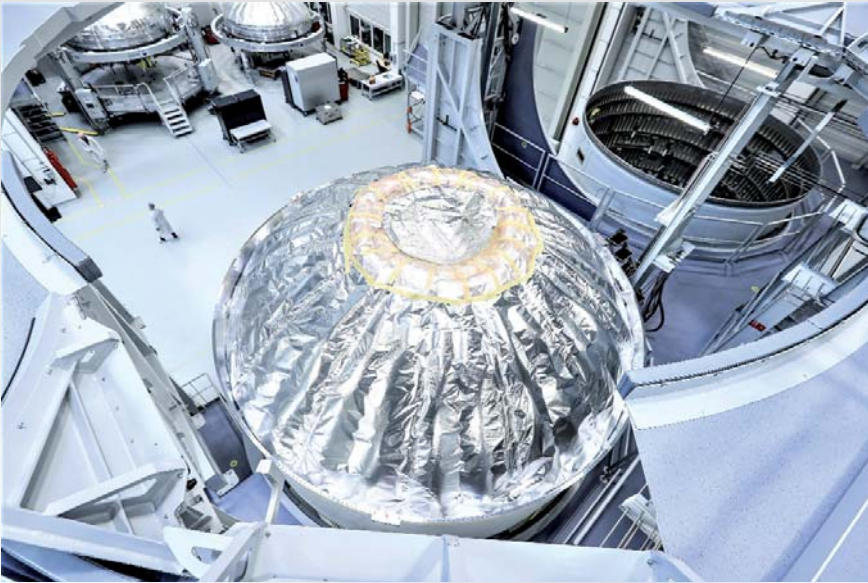
Im Hintergrund sind links der LOX-Tank vom Flight Modell 1 (FM1) und rechts vom Hot Firing Modell (HFM) zu sehen. Im Vordergrund links der LH 2 -Tank vom CTM (Combined Test Modell) und rechts die obere Intertankstruktur (L-ITS) für das HFM. Das CTM (Unterstufe aus Les Mureaux, Oberstufe aus Bremen) ist das Testmodell, um in Kourou zusammen mit den Bodenanlagen erprobt zu werden. Das HFM (nur Oberstufe) wird in Lampoldshausen „heiß“ getestet, d.h. das Triebwerk wird gezündet.
