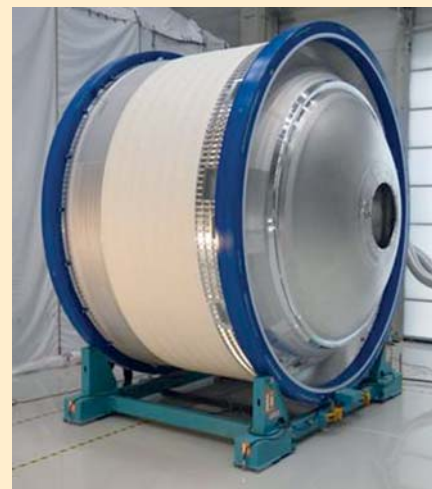
Der Tank mit einem Durchmesser von 5,4 Metern und einem Volumen von 73,61 m 3 wird mit mehr als 4,9 t flüssigem Wasserstoff befüllt. Die für die speziellen Bedürfnisse von Bremer Ingenieuren entwickelte Sprühisolation hält den Wasserstoff während des mehrstündigen Fluges ins All auf einer Temperatur von -253°C entsprechend 20 K.
