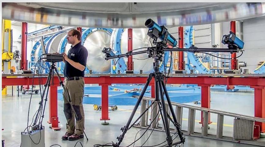
Berührungslose 3D-Erfassung eines Ariane-Bauteils mit extremer Genauigkeit („Photogrammetrie zur Qualitätssicherung in der Serienfertigung“). Foto: GDV Systems
