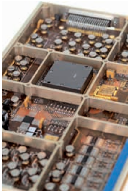
Das digitale Herz der Instrument Power Unit für die Deutsche EnMAP-Mission. Ausführung noch in herkömmlicher gemischter Bauform mithilfe von THT- und SMT-Technologie. Design und Fertigung stammen von ASP. Der Endkunde ist das Deutsche Zentrum für Luft- und Raumfahrt.
