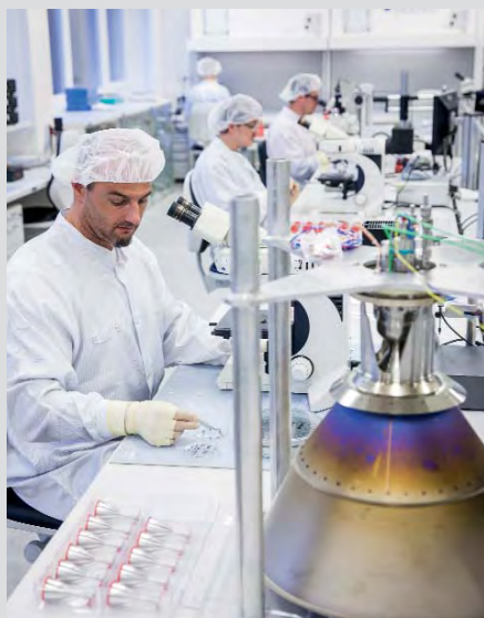
Integration von Satellitentriebwerken in Lampoldshausen.
