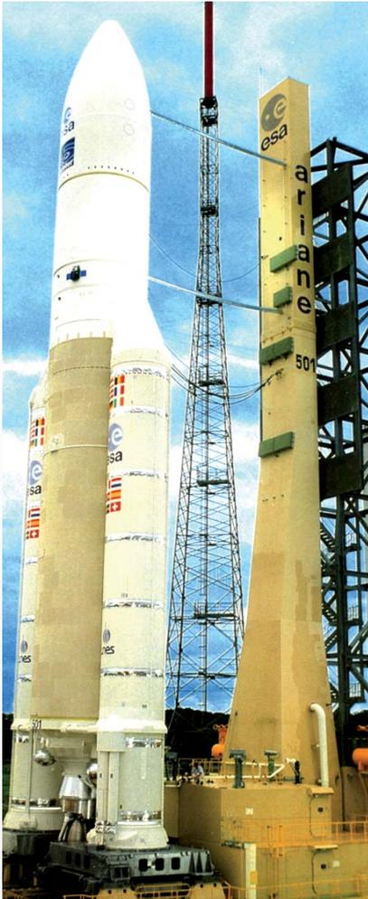
Am 4. Juni 1996 endete der Erststart der Ariane 5 (Flug V88, Seriennummer 501) durch einen Softwarefehler in der Steuereinheit bereits nach 40 Sekunden mit der Selbstzerstörung, weil die Rakete vom Kurs abkam. Die vier Cluster-Satelliten gingen verloren.
