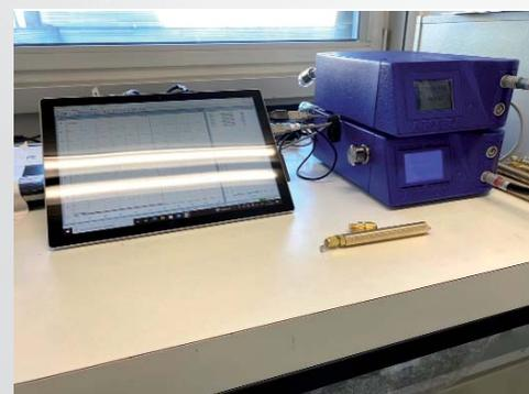
Die Sorptionsröhrchen werden in die EDU geladen und dort erhitzt. Dabei lösen sich die Moleküle vom Sorptionsmaterial und können so auf einer Trap angereichert werden. Nach zwei Minuten wird die Trap über eine Transferline in die E-Nose entleert, wo die Moleküle auf das Sensorarray aus 10 Metalloxid-Halbleitern treffen. Die dadurch induzierten Änderungen der Leitfähigkeit werden mit einem Tablet aufgezeichnet und gespeichert. Fotos: LMU
