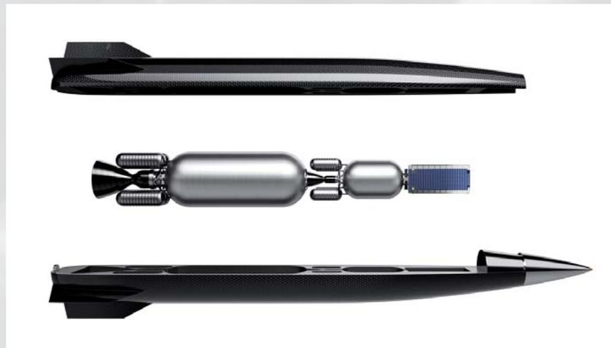
Die zweistufige Rakete im Projektil; rechts sitzt die Nutzlast, ein kleiner Satellit. Foto: SpinLaunch
