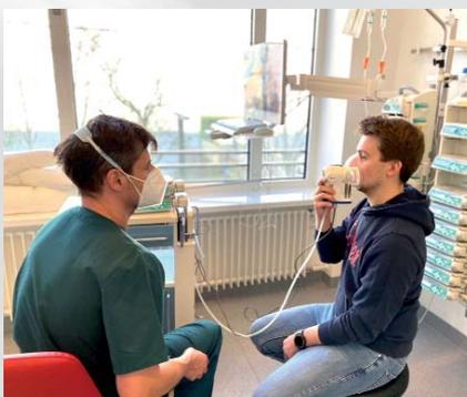
Florian Pfeiffer demonstriert an der LMU München die Anwendung der elektronischen Nase. Der Proband atmet für 5-10 Minuten unter kontinuierlichem Sauerstofffluss über die Maske. Die Sensoren des Breath Samplers erkennen den Atemzyklus und können so Luft aus oberem und unterem Atemweg getrennt sammeln. Die ausgeatmete Luft wird mittels Pumpen auf Sorptionsröhrchen geladen und so transport- und lagerungsfähig gemacht.
